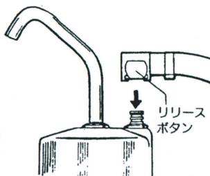
9. QDホース先端のアタッチメント部にリリースボタンを押しながら、本体のオス側の上からカチッと音がするまで押し込みます。
