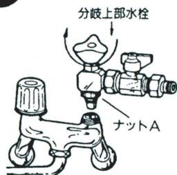
6. ハンドルを回しながら本体内に分岐上部水栓をねじ込み、自在レンチ（スパナ）でナットAを締めて下さい。
