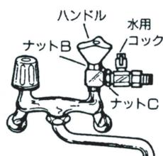
7. 分岐上部水栓の方向をご希望の位置に決め、ナットBを締めて下さい。
